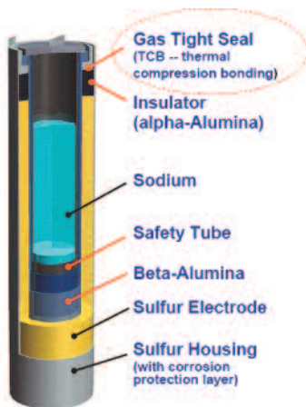
그림 1. 나트륨-유황 전지 구성 및 금속/세라믹 접합 부분
