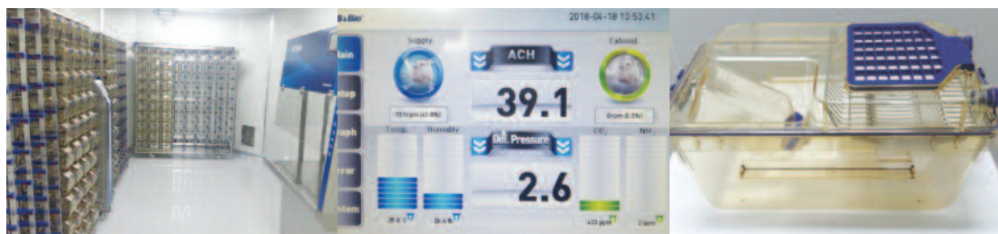
기초과학연구원 동물 사육 환경: 차로로 SPF 사육실 내부 MC 시스템/온도, 습도, 환기횟수 모니터링 관리/개별 환기 케이지
