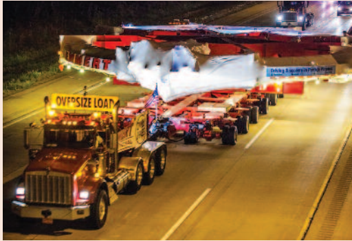
〈그림3. 2013년 미국 브록헤이븐 국립연구소에서 페르미랩으로 5000km 운반 중인 뮤온 저장링. 페르미국립연구소 제공〉
