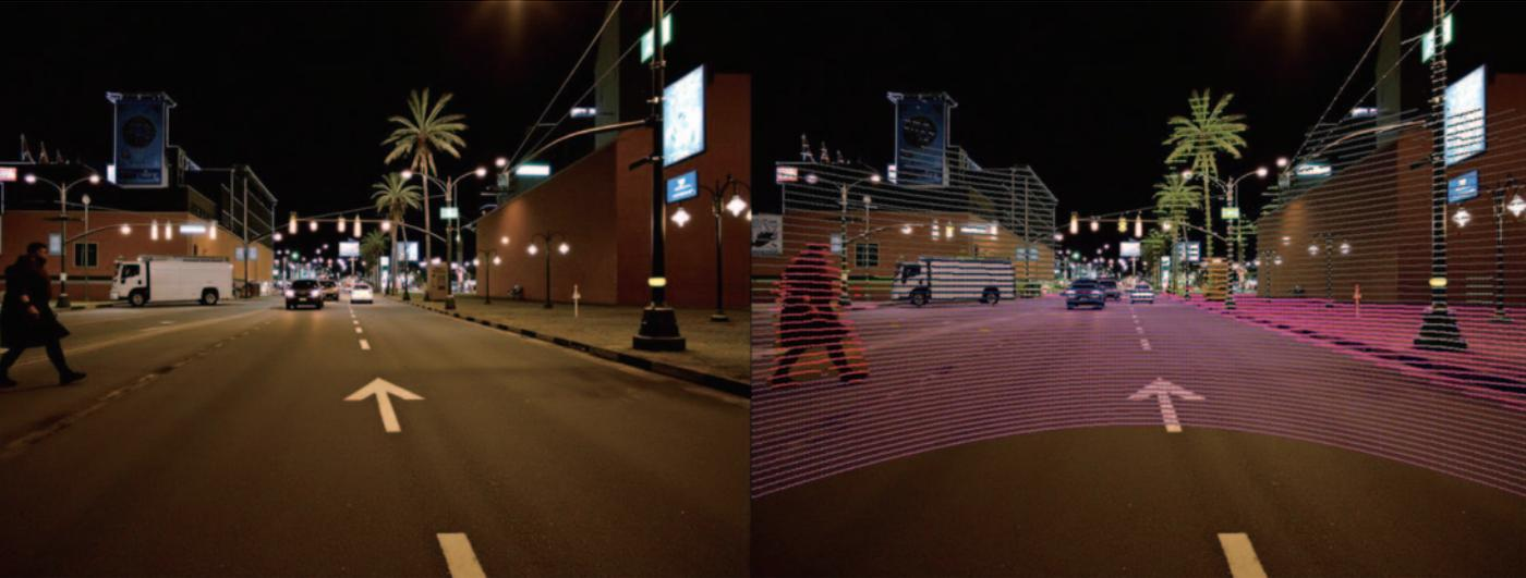
Figure 2 자율주행 상황에서 RGB 이미지와 LiDAR 포인트를 동시에 생성한 데이터 예시. 젠젠시는 단순한 이미지 생성에 그치지 않고, 예시처럼 LiDAR 포인트의 semantic label과 같은 학습용 정답 데이터까지 함께 생성하여 제공합니다. RGB뿐 아니라 IR, LiDAR, Radar 등 다양한 센서 기반 데이터와 그에 맞는 정밀한 라벨까지 자동으로 구성하는 것을 목표로 하고 있습니다.
