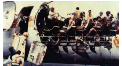
그림 1 1988년 Aloha flight 243기가 운행도중 피로파괴에 의해 비행기 지붕이 파괴되는 사고가 발생하였다.
