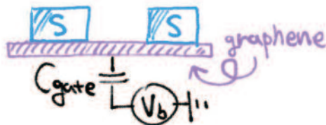
그림 4 그래핀 조셉슨 접합의 구조
