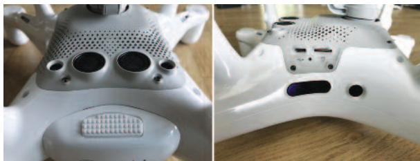
DJI Phantom4 pro에 장착된 비전 센서(좌, 우) 및 초음파 센서(좌)들
