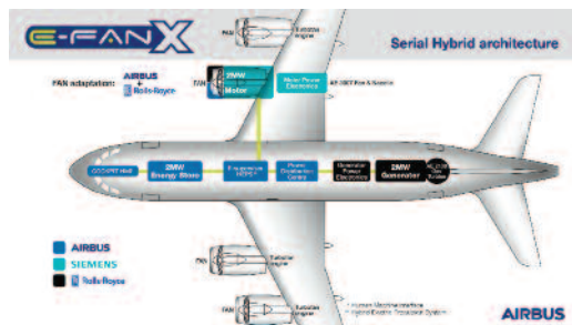
하이브리드 비행기 개념도. 엔진 4개 중 하나에 전동 모터를 장착한다. (사진 출처 _ 에어버스)
