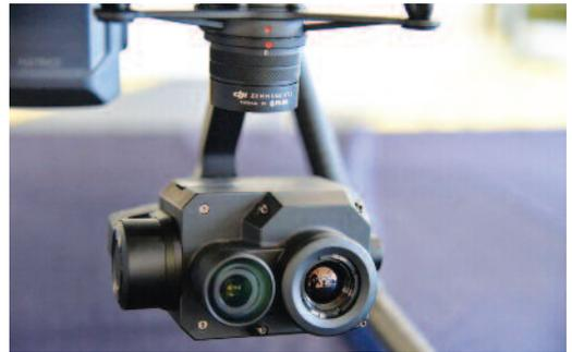
드론 제조사의 선두를 지키는 DJI 제품답게 산업용 드론 매트리스(Matrice)200, 매트리스600과 완벽하게 호환돼 눈, 비, 연기, 안개 속을 뚫고 드론과 열화상 카메라를 운용할 수 있다. 첨단 열화상 센서는 인프라 시설 모니터링, 에너지 관련 검사, 소방 활동, 수색 및 구조 임무 등에 고감도 이미지를 제공한다. 완전 일체형 이중 페이로드를 통해, 전문가들은 한 번의 비행으로 실용적인 열화상 및 실화상 데이터를 수집하여 시간, 비용을 절약하고 인명을 구할 수 있다.
